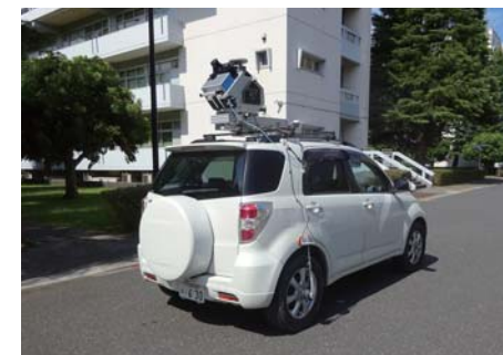
MMS の機器構成 (Trimble MX8)
