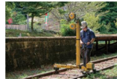
鉄道 MMS による曲線部計測実験
