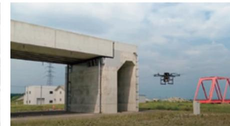
福島ロボットテストフィールドでの UAV レーザによる橋梁点群計測実験
