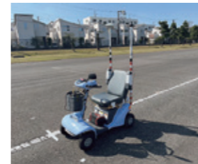
低価格GNSS移動端末の挙動計測実験機器 いすみ鉄道国吉駅のSfMで作成した3Dモデル
