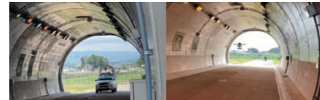
福島ロボットテストフィールドでのMMS（左）、UAVレーザ（右）によるトンネル内計測実験
