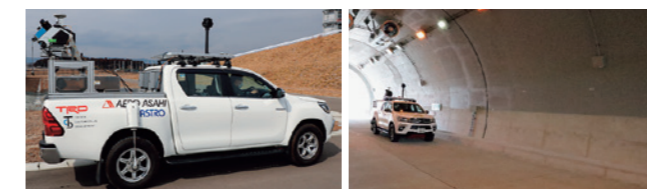
図1 実験に使用した MMS 車両 図2 トンネル内走行実験
