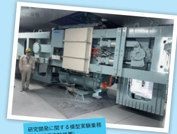
研究開発に関する模型実験業務 (遠心載荷実験装置)
