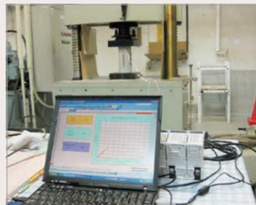
圧縮強度試験(ひずみ値のモニタリング)
