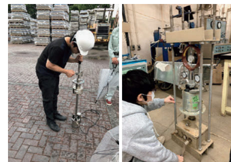
小型FWDを用いた現場試験 室内CBR試験
