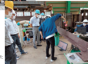
企業および学協会と連携して実施した腐食鋼桁の3Dスキャナ測定の様子
