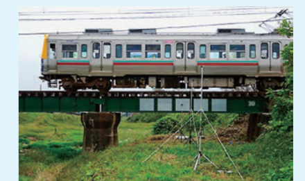
写真2：上毛電気鉄道の橋梁で実施した制振材を用いた騒音振動対策試験の様子
