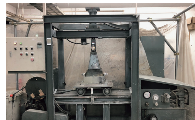
▲写真-5 舗装用強化ジオテキスタイルの耐久性試験
