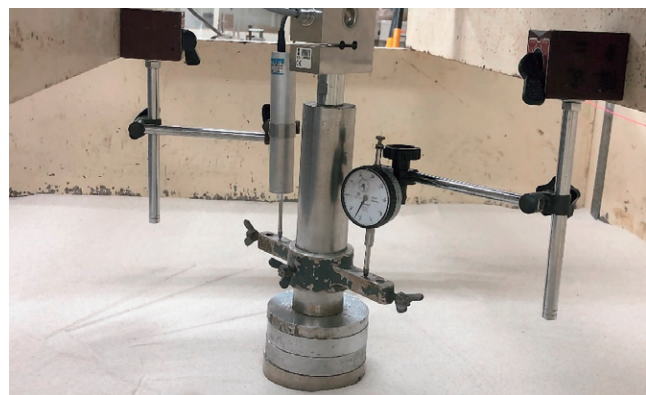
▲写真-3 模型地盤中に敷設されているジオセルに外力を加えているところ
