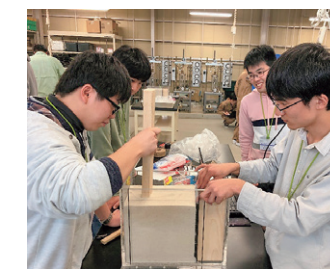
模型地盤を作製している様子 (補強材を地盤中に敷設して締め固めているところ)
