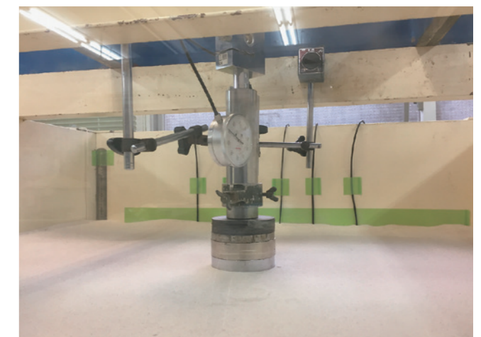
写真3 室内模型実験(白く見える砂の下にジオセルが埋まっています)
