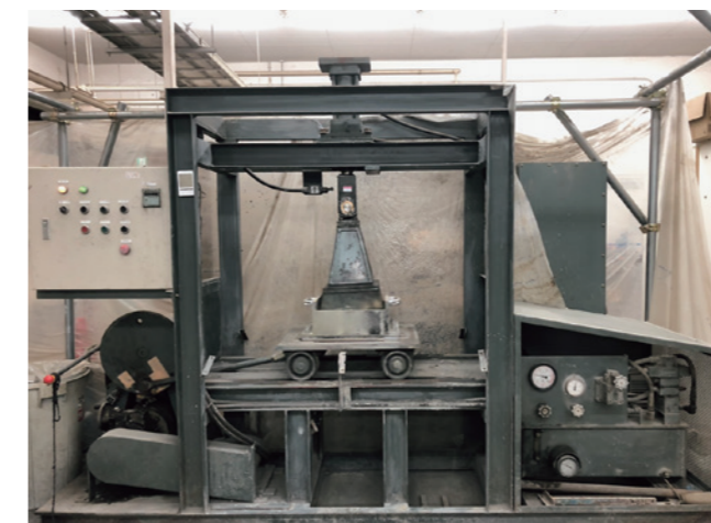
写真1 ローラコンパクタを使用した表面強化不織布の耐久性試験
