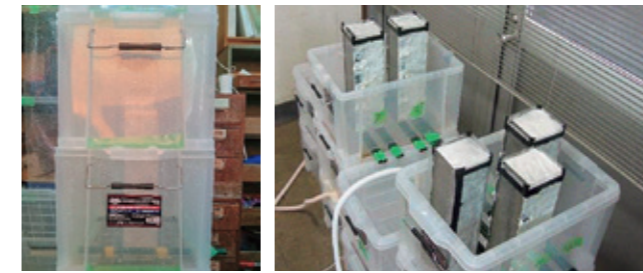
▲ 塩水流下試験状況 ▲ 塩水流下試験用供試体
