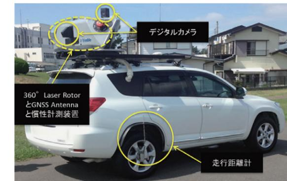
図1 モバイルマッピングシステム
