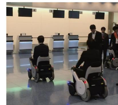
図4 使用者は操作不要な自己制御型のモビリティ
