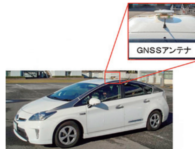
▲ 走行実験車両 (GNSSアンテナ)
