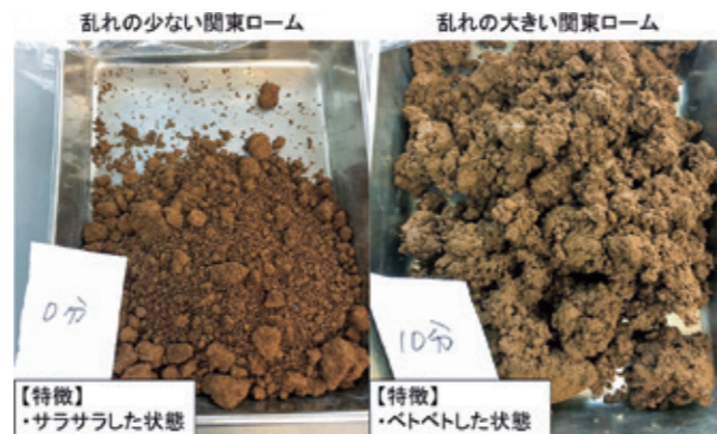
▲ 乱した状態の関東ローム
