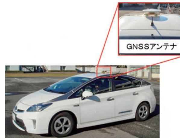
▲ 走行実験車両 (GNSSアンテナ)
