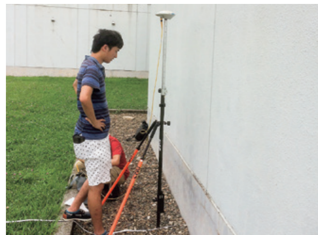
▲ 建物近傍での衛星測位実験
