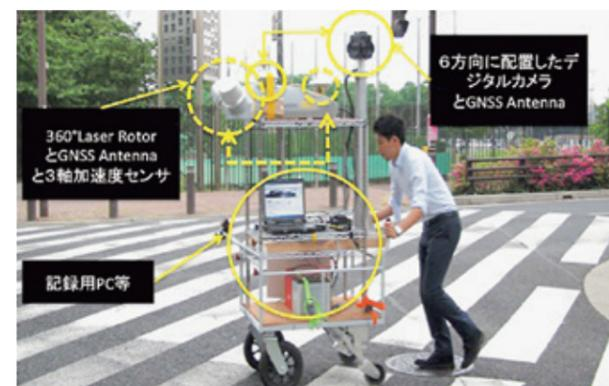
▲ 歩道計測型 MMS の概要と計測風景
