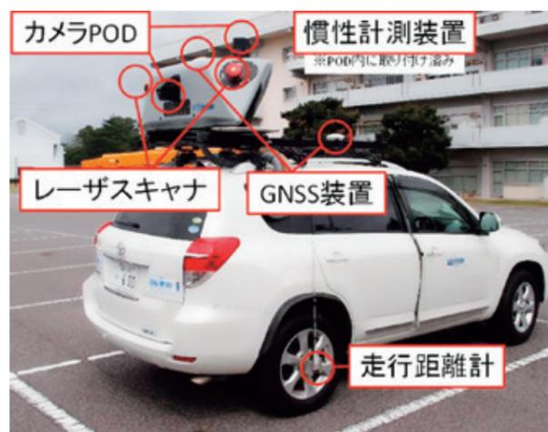
▲ MMSの機器構成 (Trimble MX8)
