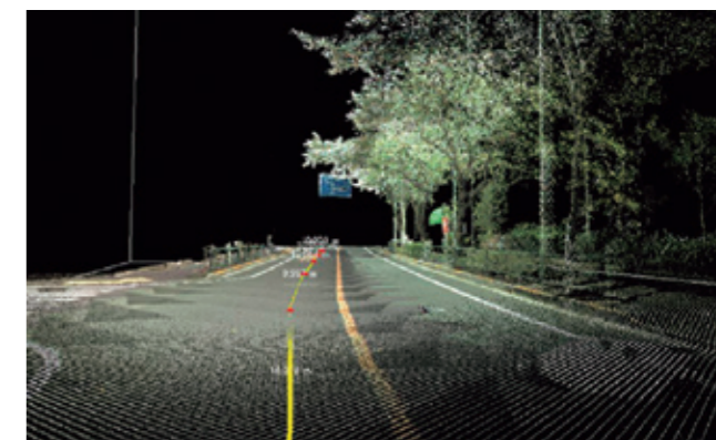
▲ MMSの点群データによる案内標識の視認性評価
