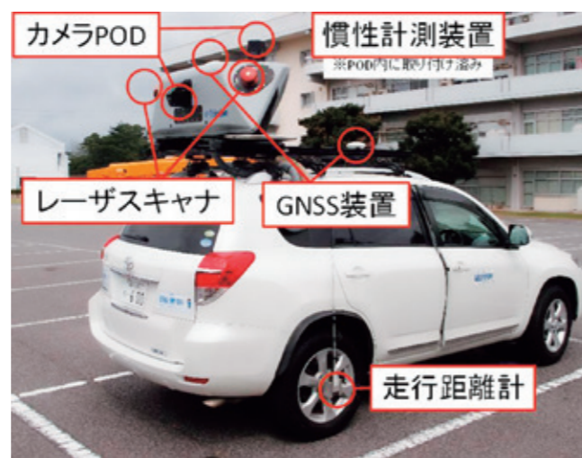
▲ MMSの機器構成 (Trimble MX8)
