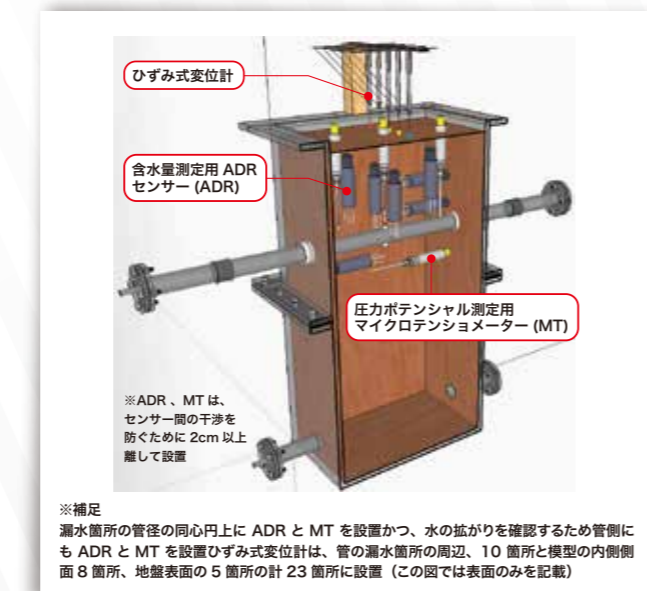
写真1 下水道管の老朽化に伴う漏水による道路陥没のシミュレーション実験
