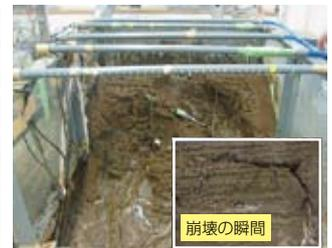
降雨による二層盛土斜面の崩壊実験
