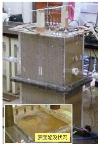
下水道管の漏水による道路陥没の
